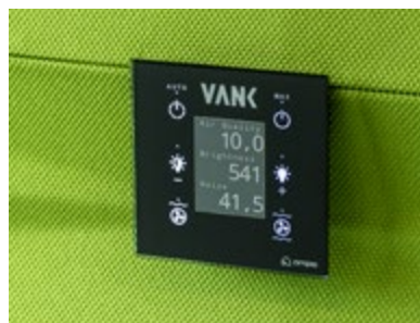
Felder-Steuerungspaneel PA-6 zur stufenweisen Einstellung von Beleuchtung und Belüftung mit Sensoren für Luftqualität, Beleuchtungsstärke und Geräuschpegel. Automatische oder manuelle Steuerung verfügbar.
